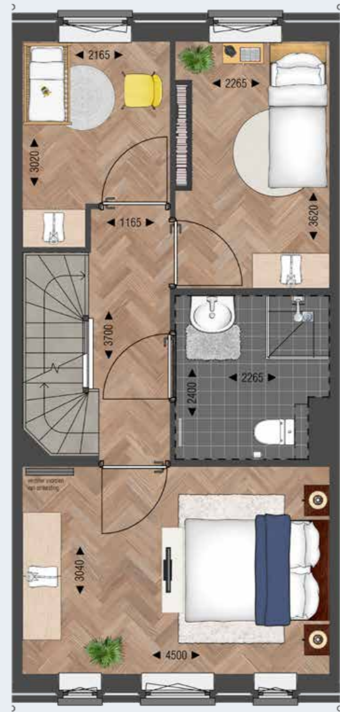
EERSTE VERDIEPING BNR. 6, 8, 10 (GESPIEGELD BNR. 7, 11)
